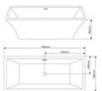
Vasca Freestanding in puro acrilico colore bianco lucido con troppo pieno. Completa di piletta di scarico click clack, sifone e tubo di scarico ø 32 mm. Supportata da struttura in acciaio inox con piedi regolabili "da cm. 0 a cm. 4 h". La vasca è realizzata in due gusci saldati, i quali conferiscono alla stessa un aspetto monolitico come se fosse un unico pezzo sia al tatto che alla vista.
