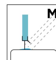
Box con sola guarnizione di protezione. Non escludono la fuoriuscita dell'acqua, anche in quantità abbondanti.
