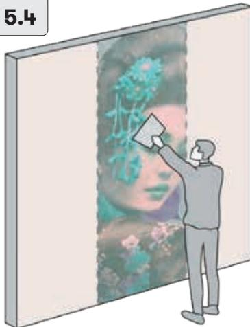
Mit einer Plastikspachtel, damit keine Beschädigungen entstehen, die Rollen gut an die Wand glätten. Falls der Kleber nicht ausreichend ist, um die gesamte Fläche zu decken, zusätzlichen Kleber auftragen, bis die gesamte Bahnoberfläche gedeckt ist.
