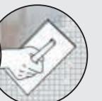
Rasare utilizzando rete da rasatura e un mix di Triblock P e sabbia di quarzo 0,25 fino a ottenere una superficie perfettamente compatta e omogenea. Se necessario, carteggiare.
