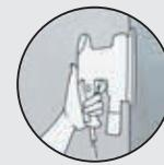
Poncer avec une ponceuse et appliquer le Triblock P jusqu'à obtenir une surface parfaitement lisse et uniforme.
