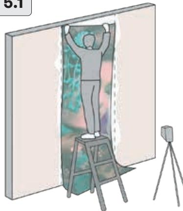
Appliquer le rouleau perpendiculairement au sol à l'aide du niveau laser, en prenant soin de laisser une excédance au plafond et au sol sur environ 5 cm.
