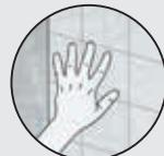
Infine, prima di procedere alla posa dei teli di EQ-dekor, verificare che la superficie sia perfettamente liscia. Se necessario carteggiare e aspirare i residui verificando anche l'uniformità della colorazione. In caso il colore non sia uniforme, colorare la superficie con smalto all'acqua bianco o grigio a seconda della tonalità della grafica scelta.
