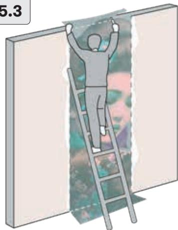
Das Übermaß an der Decke und am Boden mit einem scharfen Kutter abschneiden.
