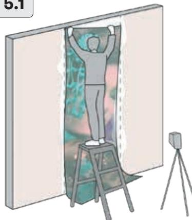
Applicare il telo in modo perpendicolare al terreno aiutandosi con la livella laser, avendo cura di lasciare dell'abbondanza sia lato soffitto sia pavimento per circa 5 cm.
