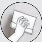
Stendere la seconda mano di Triblock P facendola aderire bene alla prima mano di rasatura utilizzando una spatola di metallo o rullo. A completa asciugatura, carteggiare.
