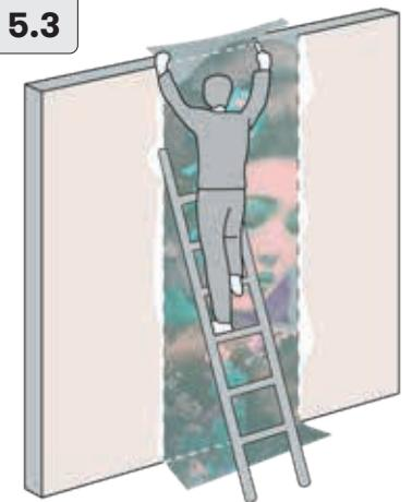
Cortar el exceso de material en el techo y el suelo con un cortador afilado.
