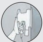
Poncer avec une ponceuse ou raser jusqu'à obtenir une surface parfaitement lisse et régulière.
