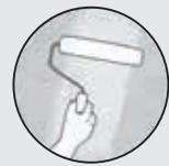
Die Oberfläche mit einem Schleifgerät schleifen und Triblock P auftragen, bis eine perfekt glatte und gleichmäßige Oberfläche erreicht ist.
